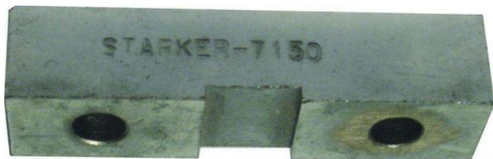
215 110 | SMONTA POMPA INIEZIONE
